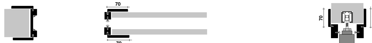
Coprifili telescopici davanti e dietro (escursione max mm 10) Front and back telescopic trims (max travel range 10 mm)
