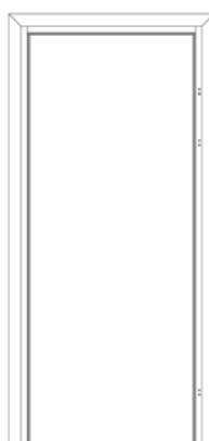
4. Ościeżnica regulowana z panelem górnym podwyższonym od 261 mm do 1000 mm. Listwa opaskowa 60/20 mm lub 80/20 mm
